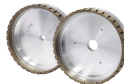
X004 斜边机钢轮(A型) Bevel diamond wheel ( Type A ) 规格/SIZE : 150×8×10(mm) 外齿(Outer segment) 孔径/HOLE : 12mm, 22mm, 50mm 目数/MESH : 80#, 120#, 140#, 180#
